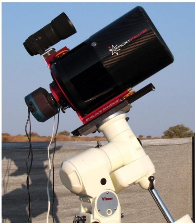
Die Zeit zum ausgiebigen Testen vor dem Urlaub wurde knapp, schon wegen der kurzen Nächte im Sommer. Ich habe den Fokussierer selbst umgebaut und dabei die fragwürdigen Unterlegscheiben, die im Originalzustand als Federn in der Druck-/Zugverstellung verbaut sind, gegen passende Federn von Gutekunst ausgetauscht. Die Tests zu Hause waren vielversprechend, das Prinzip der Justierung klar. Ich plante daraufhin, die Justierarbeiten vor Ort abzuschließen.
